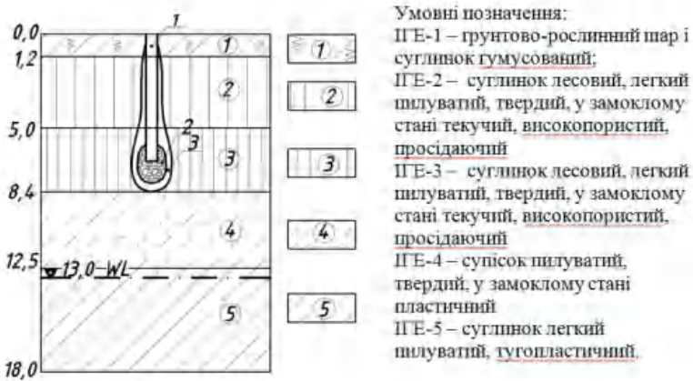
Рис. 1. Інженерно-геологічна колонка дослідного майданчика з прив'язкою набивної палі у пробитій свердловині: 1 – стовбур набивної палі у пробитій свердловині; 2 – розширення цієї палі з втрабованого щебеню об'ємом V_{cr}=1,5 \text{ м}^3 ; 3 – зона достатнього ущільнення ґрунту
