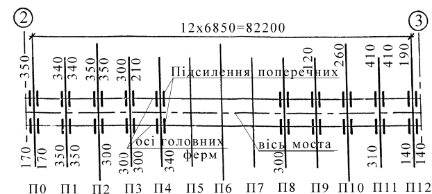
Рис. 3. Поперечні балки прогонової будови 2-3, які підлягали підсиленню
