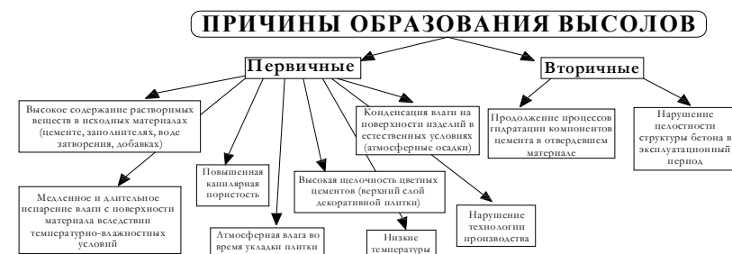
Рис. 1. Причины образования высолов на цементно-песчаных изделиях
