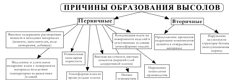
Рис. 1. Причины образования высолов на цементно-песчаных изделиях
