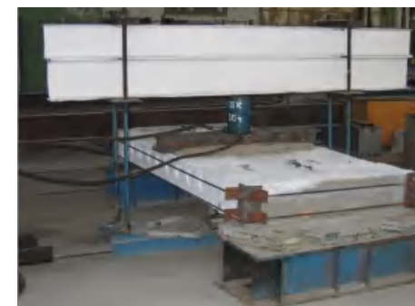
Рис. 5. Установка для испытания фрагмента перекрытия
