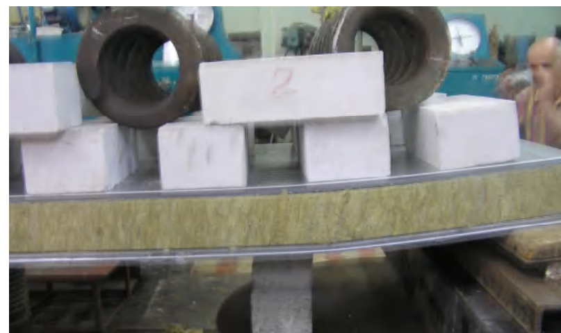
Рис. 5 Характер разрушения плит длиной 2м и 3м
