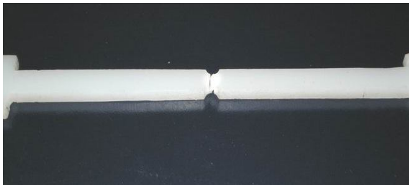
Рис.4. Образец приготовленный из монолитного поликарбоната фирмы «Stropex»– толщина образца 4 мм, цвет молочный
