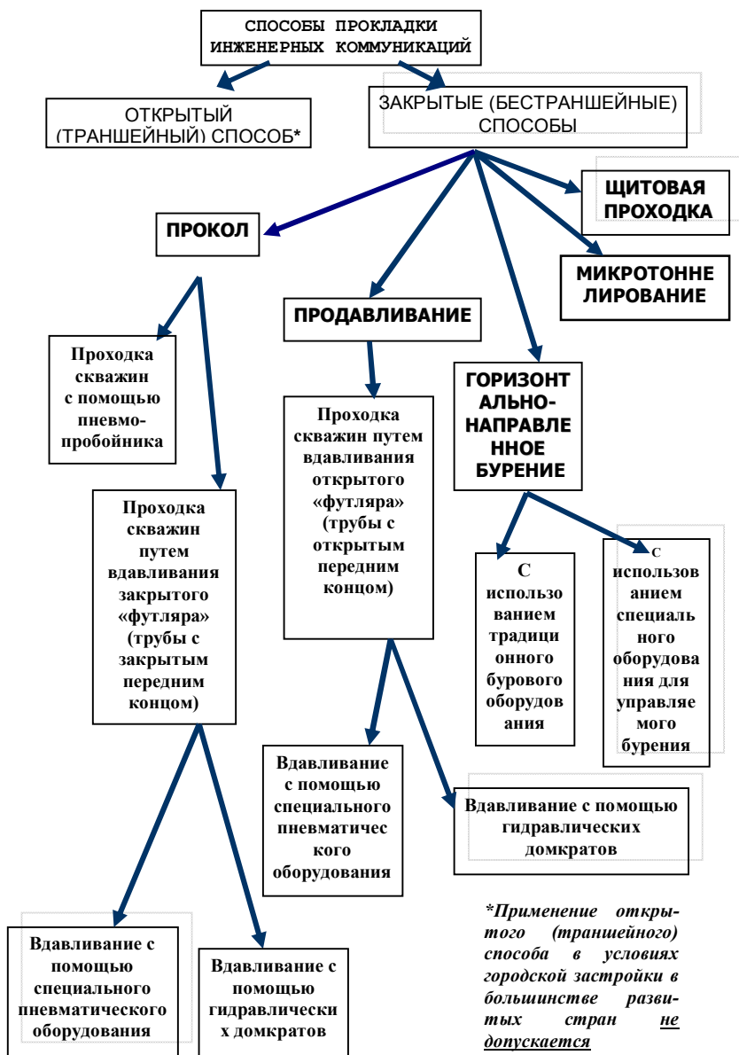
Рис. 1. Способы прокладки инженерных коммуникаций.
