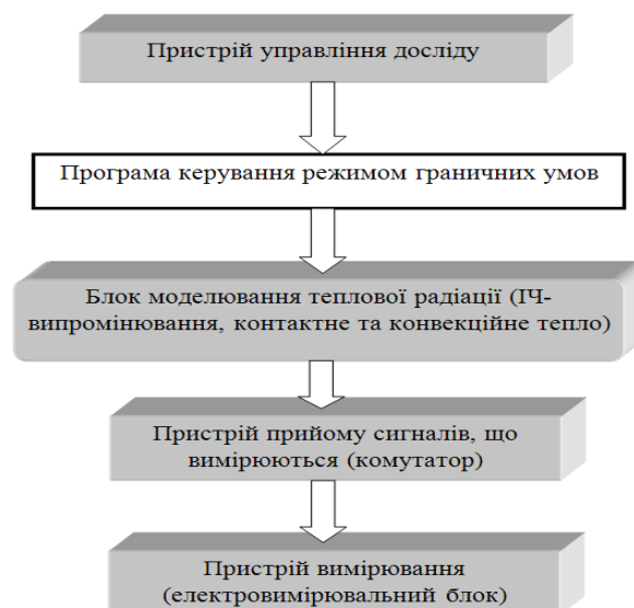
Рис. 1 – Загальна структурна схема приладу ОКЗВ-КД1./ General structure diagram of the device OKZV-KD1
