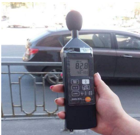
Рис. 2. Шумомір марки Testo 815 / Brand sound level meter Testo 815
