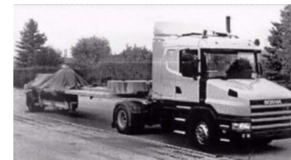
Рис. 2. Високошвидкісна установка вимірювання прогину (HSD)
