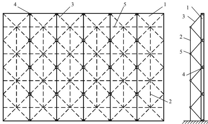
Рис.6 Вертикальна стіна з окремих лінійних сталезалізобетонних елементів:
