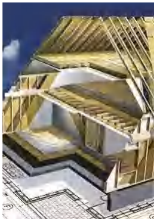
Рис.1. Каркасный деревянный дом в разрезе
