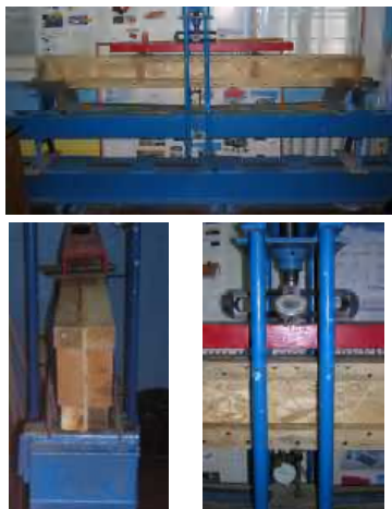
Рис. 2. Момент испытания составной двугавровой балки с поясами из деревянных брусков, соединенных со стенкой из OSB на шурупах
