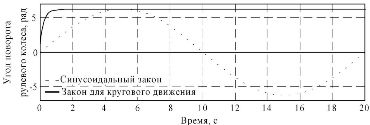
Рис. 4. Законы изменения угла поворота рулевого колеса.
