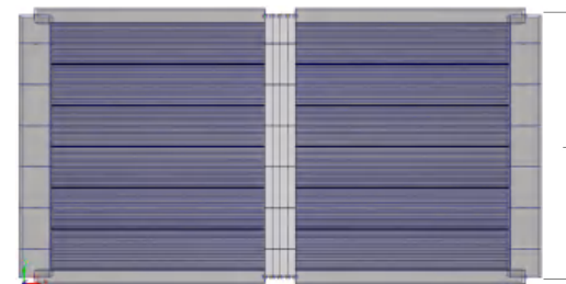
Рис.1. Ячейки плоского сборно-монолитного перекрытия пролётом 7.6 x7.6м
