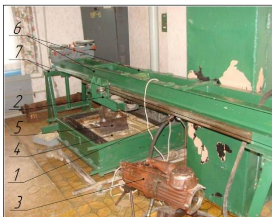
Рис. 2. Общий вид стенда физического моделирования: 1 – датчик давления; 2 – передвижная тележка; 3 – приводная масло-станция; 4 – моделируемый грунт IV категории (парафин); 6 – контейнер; 7 – модель рабочего органа; 8 – швеллерная балка конструкции стенда; 9 – жесткие опоры.
