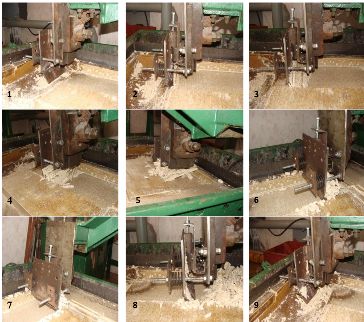
Рис. 4. Фотограмма процесса резания грунта.
