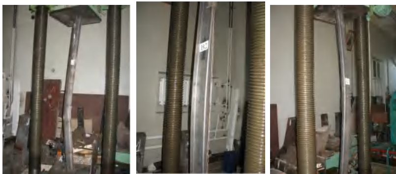
Рис. 4. Втрати стійкості стержнів під навантаженням
