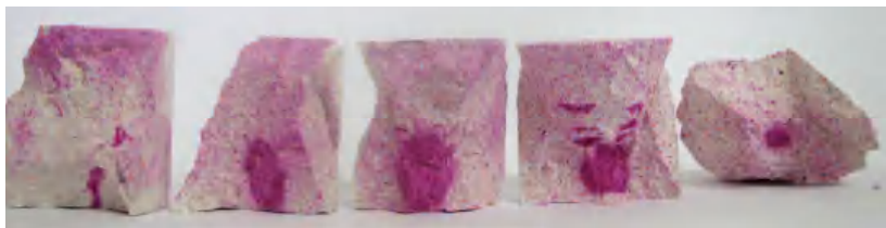
Рис. 4. Карбонизированная (неокрашенная область) и не карбонизированная (окрашенная область) слоев на сколах опытных образцов-цилиндров, полученных при P 5 МПа из известкового теста влажностью (слева направо): 15, 17,5, 20, 22,5 и 25 % мас.
