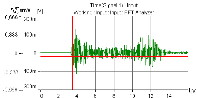
Рис. 1. – График сигнала горизонтальной виброскорости грунта возле здания Центра творчества в направлении взрыва
