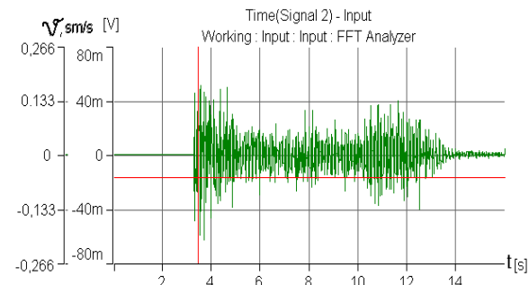
Рис. 2 – График сигнала вертикальной виброскорости грунта возле здания Центра детского творчества
