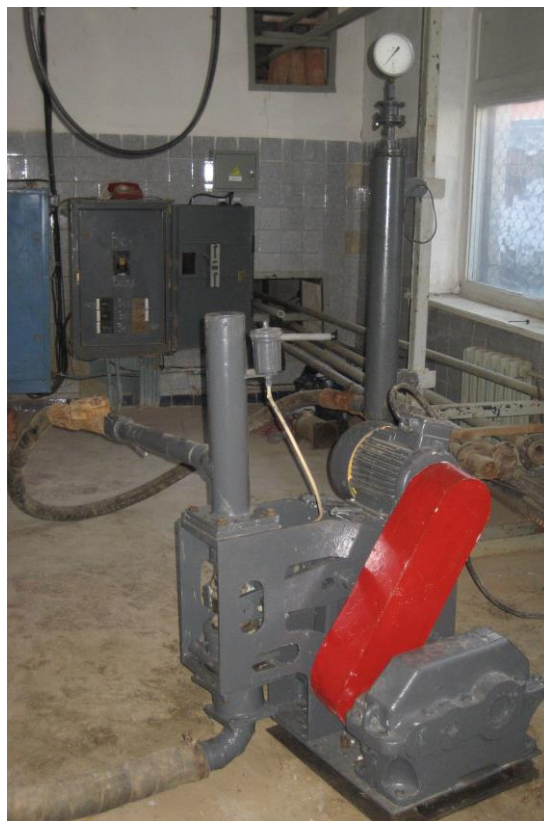
Рис. 1. Загальний вигляд диференціального розчинонасоса із вертикальним проточним плунжером РНП-4.
