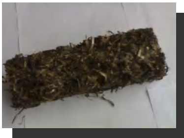
Рис. 3. Опытный образец фибролита из водорослей
