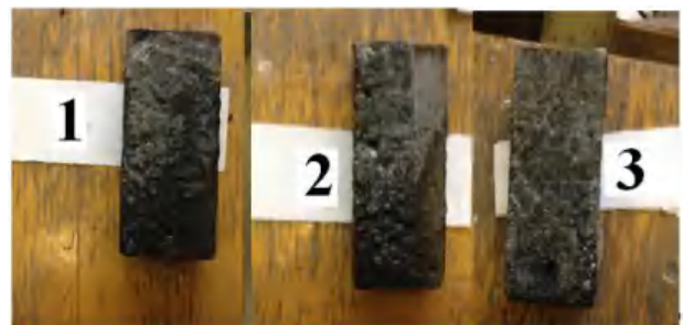
Рис. 8 Очищені і неушкоджені зразки деревини після проведених випробувань / Purified and undamaged samples of wood after the tests.
