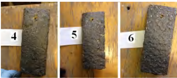
Рис. 5. Зразки з нанесеним і затверділим вогнезахисним складом перед випробуваннями / Samples with applied and hardened flame retardant before tests
