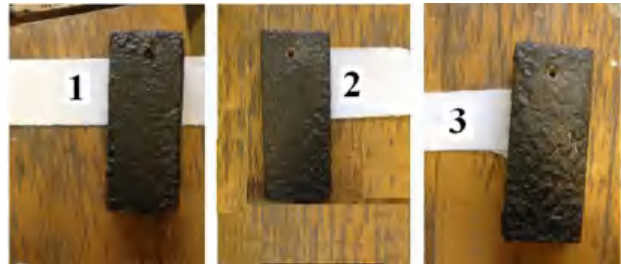
Рис. 2. Підготовлені до проведення випробувань зразки / Prepared for test samples
