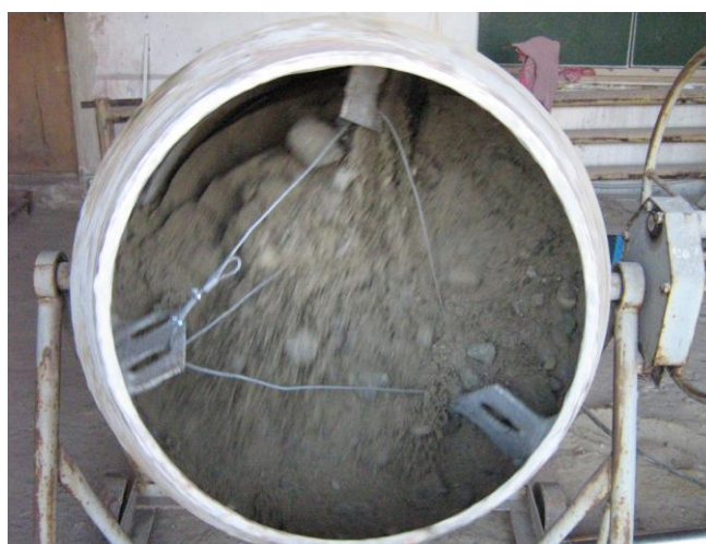
Рис. 2. Фото модернизированного гравитационного бетоносмесителя.
