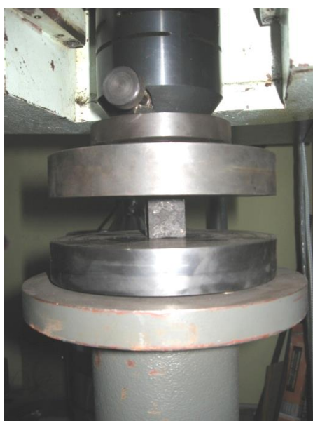
Рис.2. Размещение образцов в испытательной машине
