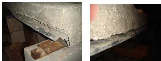
Рис. 11. Характер руйнування зразка ПМА-2/ Destruction nature of the specimen PMA-2
