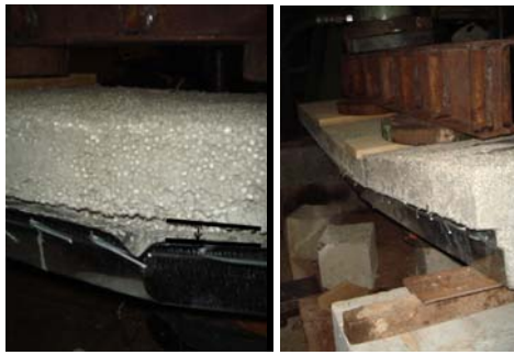
Рис. 13. Характер руйнування зразка ПМА-3/ Destruction nature of the specimen PMA-3
