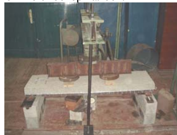
Рис. 12. Розташування зразка ПМА-3 в установці/ The location of the PMA-3 specimen in the experimental installation
