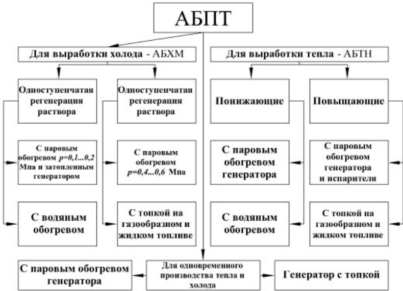
Рис. 1. Классификация абсорбционных преобразователей тепла (АПТ)
