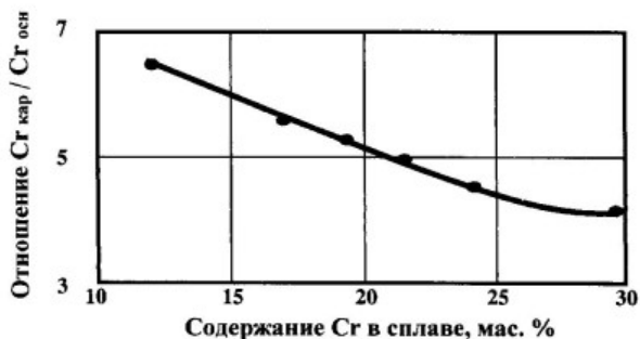
Рис. 4. Зависимость отношения Cr_{кар}/Cr_{осн} от содержания хрома в сплаве
