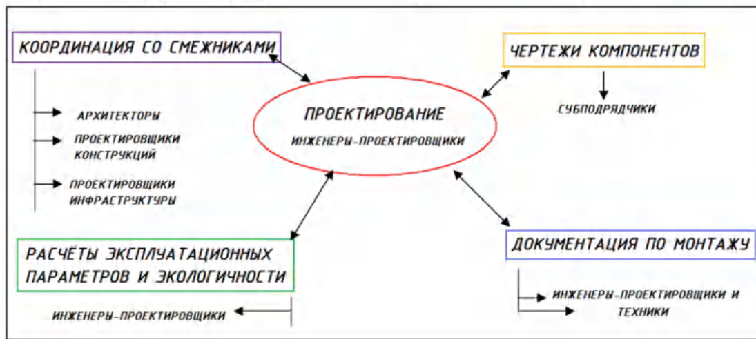
Рис. 2. Технология BIM – усовершенствованный рабочий процесс / BIM Technology - Enhanced workflow
