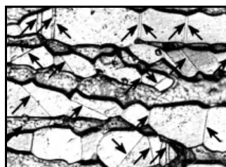
Рис. 6. Микроструктура образца трубы после двойной закалки, \times 500 .
