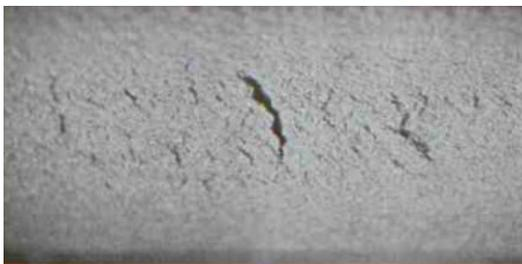
**Рис. 1.** Характерный вид дефектов на поверхности проволоки диаметром 4,0 мм после светления в 50 % водном растворе соляной кислоты ( $\times 10$ )
