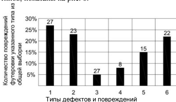
Рис. 8. Повреждаемость футеровки металлических дымовых труб / Damage to the lining of metal chimneys
