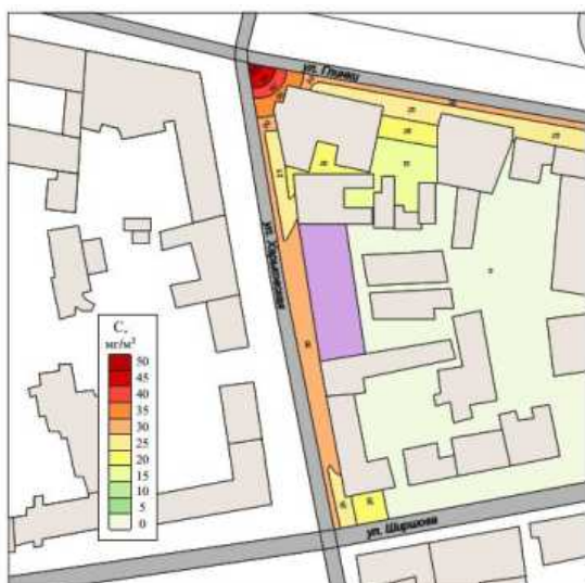
Рисунок 2 Карта загазованности для здания-памятника по адресу ул. Глинки, 2 / Figure 2 The map of gas contamination for the monument at the address: ul. Glinka, 2
