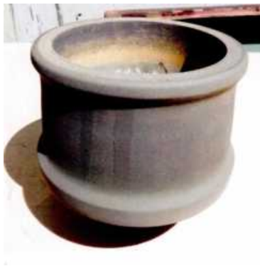
Рис.3. Общий вид корковой детали на алюминиевой модели. / Figure 3. General view of the cortical parts on the aluminum model.
