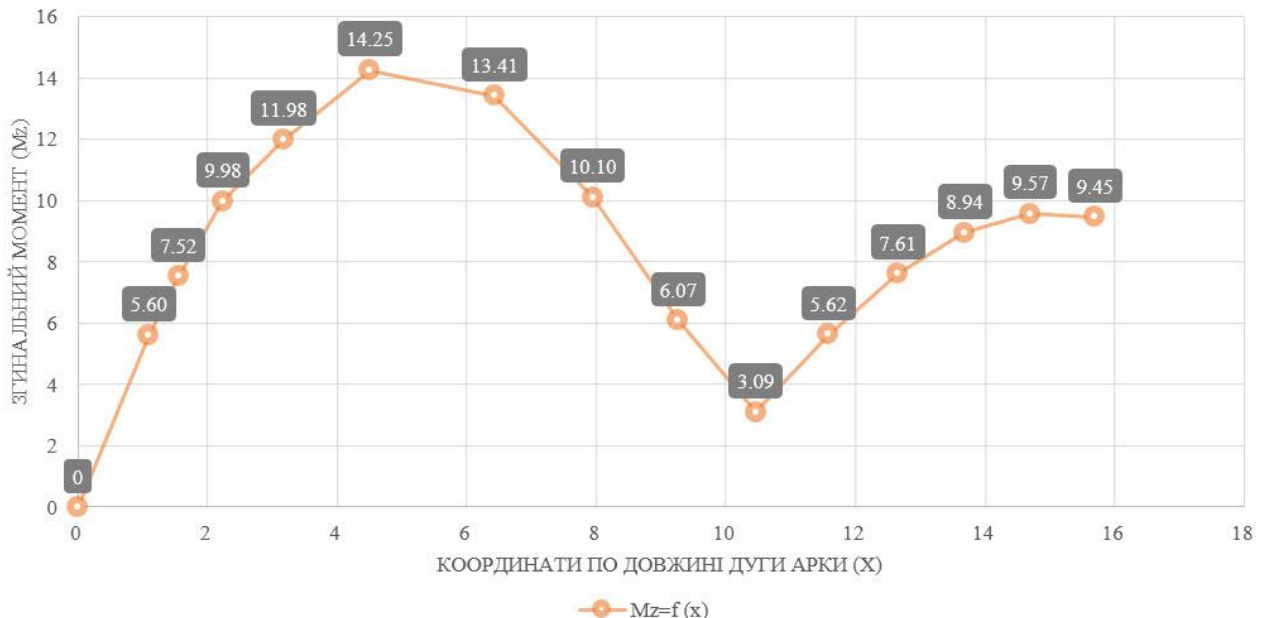
Рис. 4. Розподіл максимальних значень згинальних моментів по довжині півдуги арки
