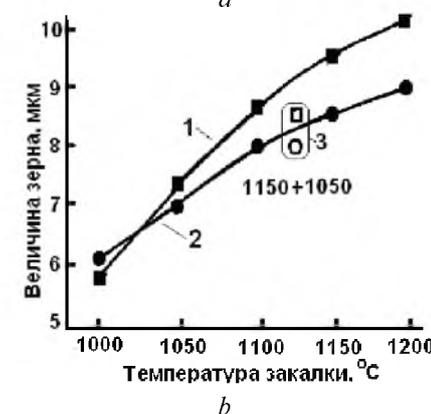
Рис. 5. Влияние режима закалки на величину ферритного (кр. 1) и аустенитного (кр. 2) зерна в образцах горячепрессованных (а) и холоднокатаных (б) труб / Effect of quenching conditions on the size of ferrite (1) and austenite (2) grains in hot-extruded (a) and cold-rolled (b) tubes
