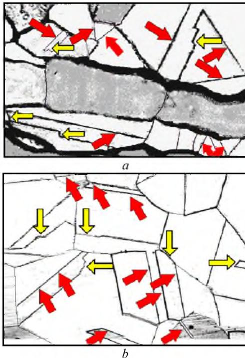
Рис. 6. Микроструктуры образцов горячепрессованных труб из стали 02X22H5AM3 (a) и 03X18H11 (б) после двойной закалки с обозначенными специальными границами  $\Sigma 3$ ,  $\times 800$  / Microstructure of a specimens of hot-extruded tubes from Cr22Ni5Mo3N (a) and Cr18Ni10 (b) steel after regenerative quenching with denoted special boundaries  $\Sigma 3$ ,  $\times 800$
