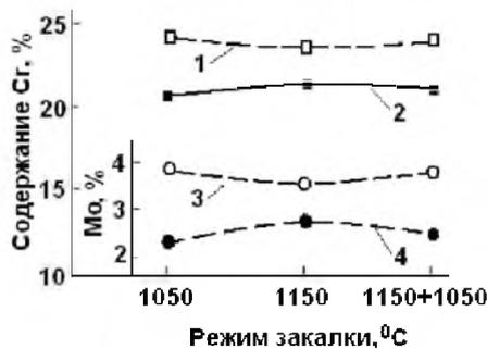
Рис. 11. Влияние режима закалки на содержание Cr (кр. 1 и 2) и Mo (кр. 3 и 4) в α и γ фазах /
