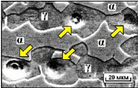
Рис. 4. Зарождение питтингов (показано стрелками) в аустенитной фазе образца трубы из стали 02X22Н5АМЗ / Pitting nucleation in austenite phase (indicated by arrows) in a specimen taken from Cr22Ni5Mo3N steel tube
