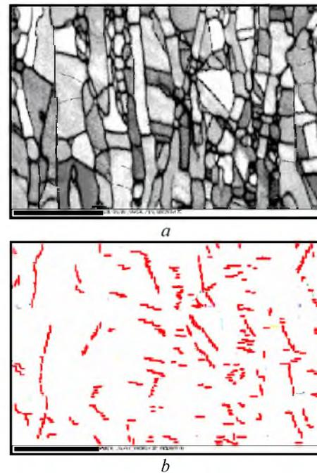
Рис. 8. Структура образца горячепрессованной трубы из стали 02X22H5AM3 после двойной закалки (метод ДОРЭ,  $\times 500$ ): a – растровое изображение зеренной структуры; b – СГ в аустените / Structure of a specimen taken from a hot-extruded tube of Cr22Ni5Mo3N steel after regenerative quenching (method EBSD,  $\times 500$ ): a – raster image of grain structure; b – SG in austenite
