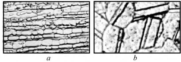
Рис. 7. Зеренная структура (a,  $\times 500$ ) и участок  $\gamma$ -фазы (b,  $\times 1500$ ) в образце холоднокатаной трубы после двойной закалки / Grain structure (a,  $\times 500$ ) and a section of  $\gamma$ -phase (b,  $\times 1500$ ) in a specimen taken from a cold-rolled tube after regenerative quenching
