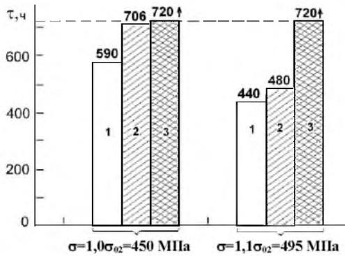
Рис. 10. Влияние режима закалки (°С) на стойкость против СКРН образцов холоднокатаных труб: 1 – 1050; 2 – 1150, 3 – (1150+1050) /
