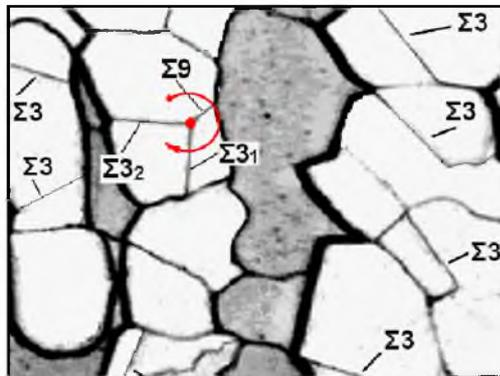
Рис. 1. Пример определения СГ  $\Sigma 3$  и  $\Sigma 9$  / Example of determination of SG  $\Sigma 3$  and  $\Sigma 9$
