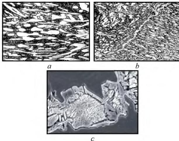
Рис. 2. Микроструктура трубной заготовки из стали 02X22H5AM3: a, b – центр и периферия,  $\times 250$ ; c –  $\sigma$ -фаза,  $\times 10000$  /
