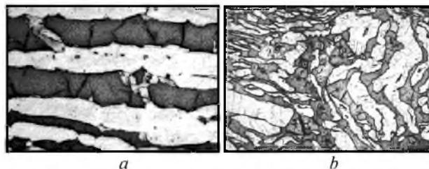
Рис. 3. Микроструктура горячепрессованных труб из стали 02X22H5AM3,  $\times 500$ : a, b – продольный и поперечный шлифы, соответственно /
