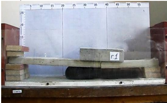
Рис.11 Характер взаимодействия на моделях из эквивалентных материалов падающего породного блока различной массы m , (кг) с балкой, которая опирается на закладочный массив жесткостью C=15695 Н/м; а) m=0,55 кг, m=0,92 кг.
