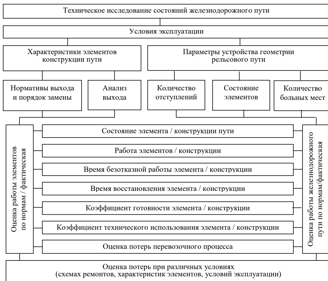
Рис. 1. Алгоритм метода оценки деформативной работы железнодорожного пути / Algorithm for estimating the deformative work of a railway track
